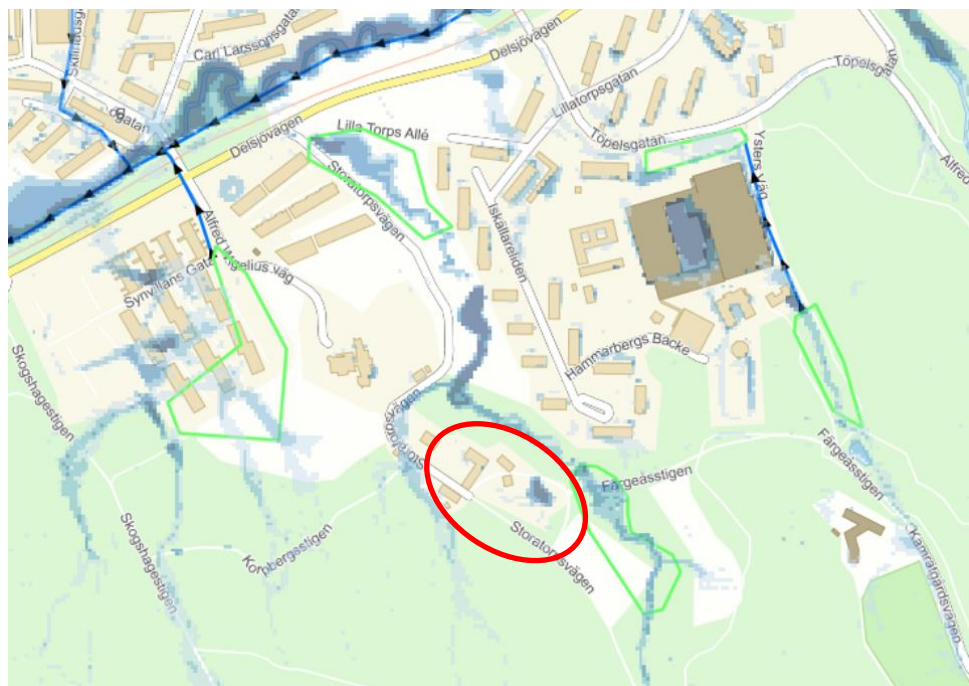
Figur 10. Skyfallssituation för omgivning utanför planområdet och vid ett skyfall (100 års återkomsttid). Planområdet är markerat med en röd ring och visas i detalj i Figur 11 (GoKart).
